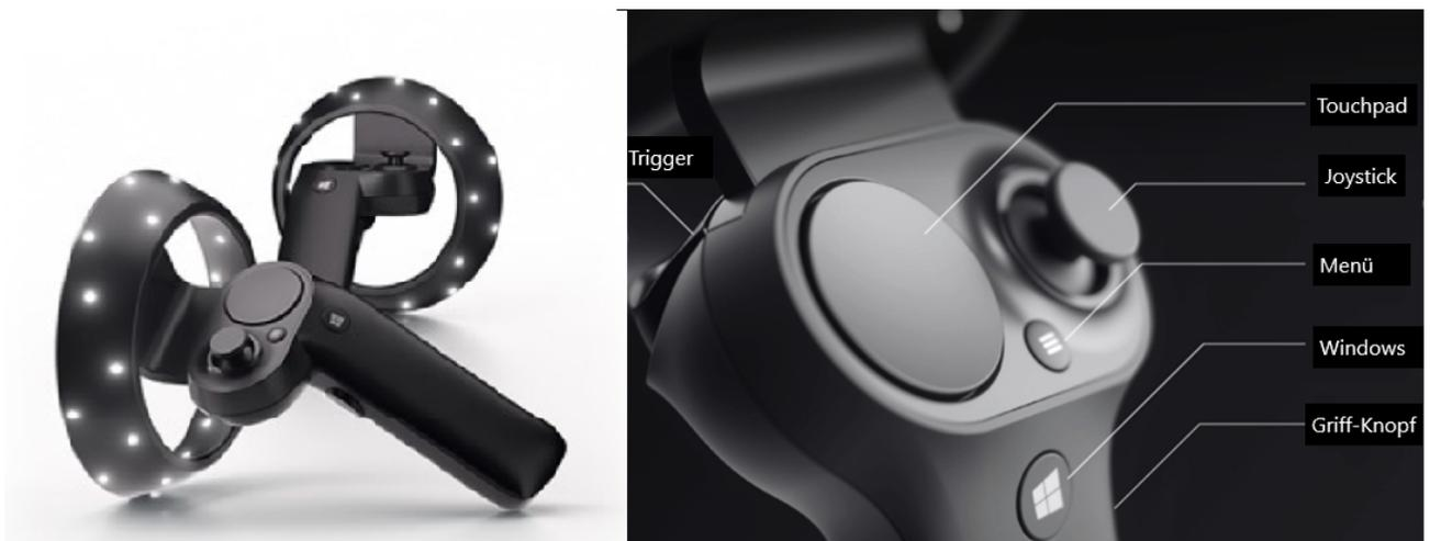
Abbildung 5.2: Interaktion mittels MR Controller [60]
