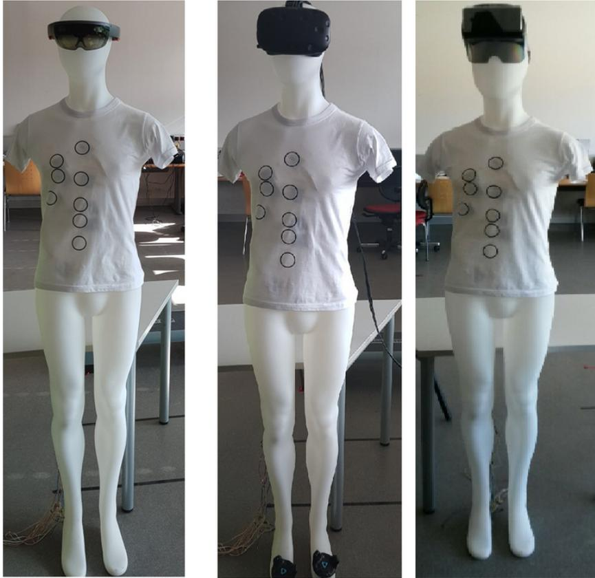
Abbildung 9.1: Befestigung der HMDs auf der Messpuppe
